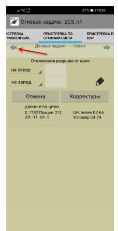
1. Поставить метку в поле «Отклонение разрыва от цели». Появится прицельная метка и дополнительное поле с данными по разрыву. Перемещая карту, подводите прицельную метку на разрыв. Нажав на стрелку «Пристрелка» возвращаетесь вкладу пристрелки, при этом ячейки «Отклонения разрыва от цели» будут заполнены. Нажать на ярлык «Корректуры», ниже вы получите корректуры в дальности, прицел и доворот.
