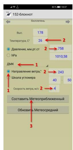
9.2 Если направление и скорость ветра ( дальность сноса пуль ) определялись с помощью ВР-2, на выпадающей вкладке должно быть «**ВР-2**».
