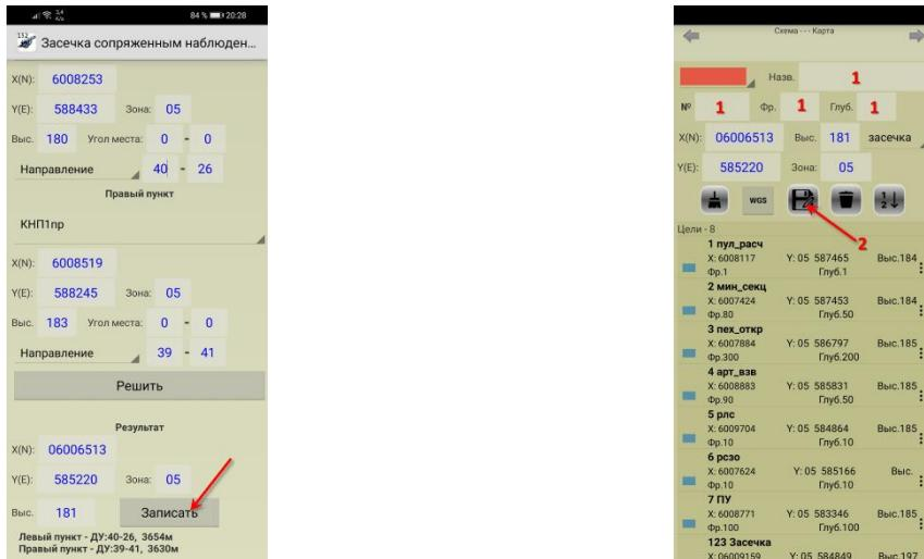
6.2 Определение координат цели неориентированным прибором. Если на НП у неориентированные приборы, тогда под координатами НП должна быть выпадающая вкладка «Отсчет от базы». Заполняете ячейки вписывая углы (углы должны отсчитываться от базы между НП) по цели с левого и правого НП (при необходимости заполняем «угол места» цели с НП).
