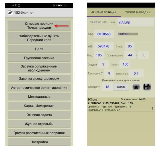
2.2 Если у вас нет прямоугольных координат ОП, но имеются координаты в системе WGS84, нажимаете на ярлык «WGS84» и вписываете в соответствующие ячейки координаты ОП, затем нажимаете на ярлык «преобразовать» и получаете прямоугольные
