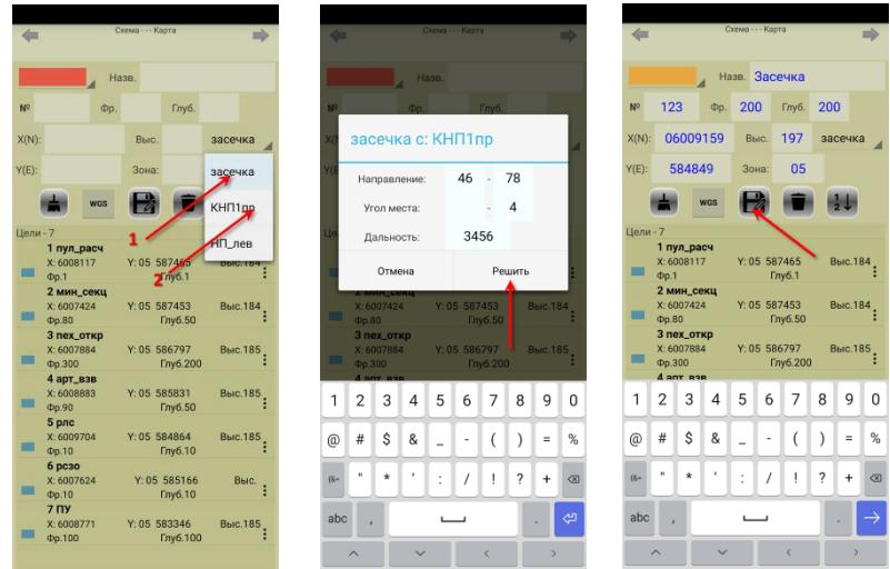
4.3 У вас есть координаты цели в системе WGS84 – нажимаете на ярлык «**WGS**», вписываете координаты в открывшееся поле, нажимаете на ярлык «**преобразовать**» и получившиеся координаты записываете, нажав на ярлык «**сохранить**». Остается заполнить пустые ячейки и нажать ярлык «**сохранить**».
