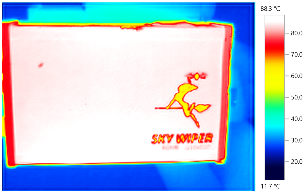
Рисунок 2. Температура блока генераторов через 30 минут работы. Максимальное значение на корпусе - 88.3 градуса
