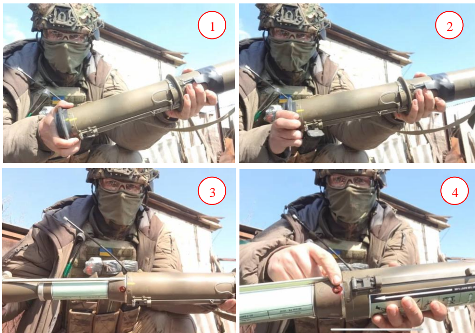
Р и с. 15. Взведение ударно-спускового механизма гранаты.
