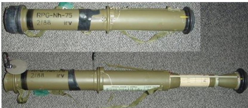
Р и с. 1. Граната RPG-75 в походном и боевом положениях.
