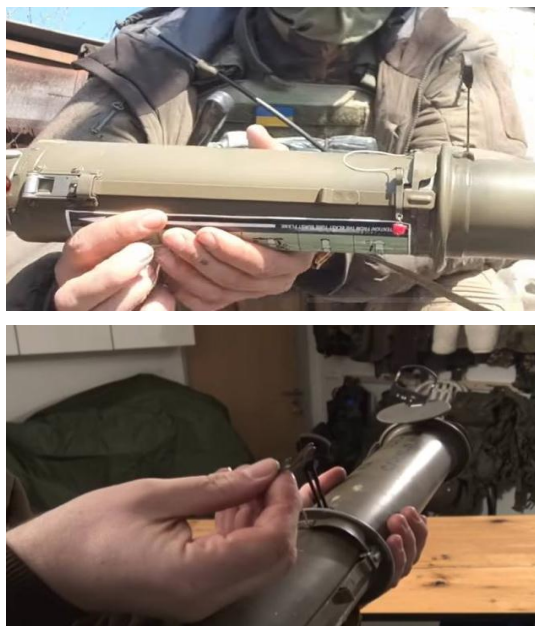
Р и с. 17. Освобождение предохранительного шплинта.
